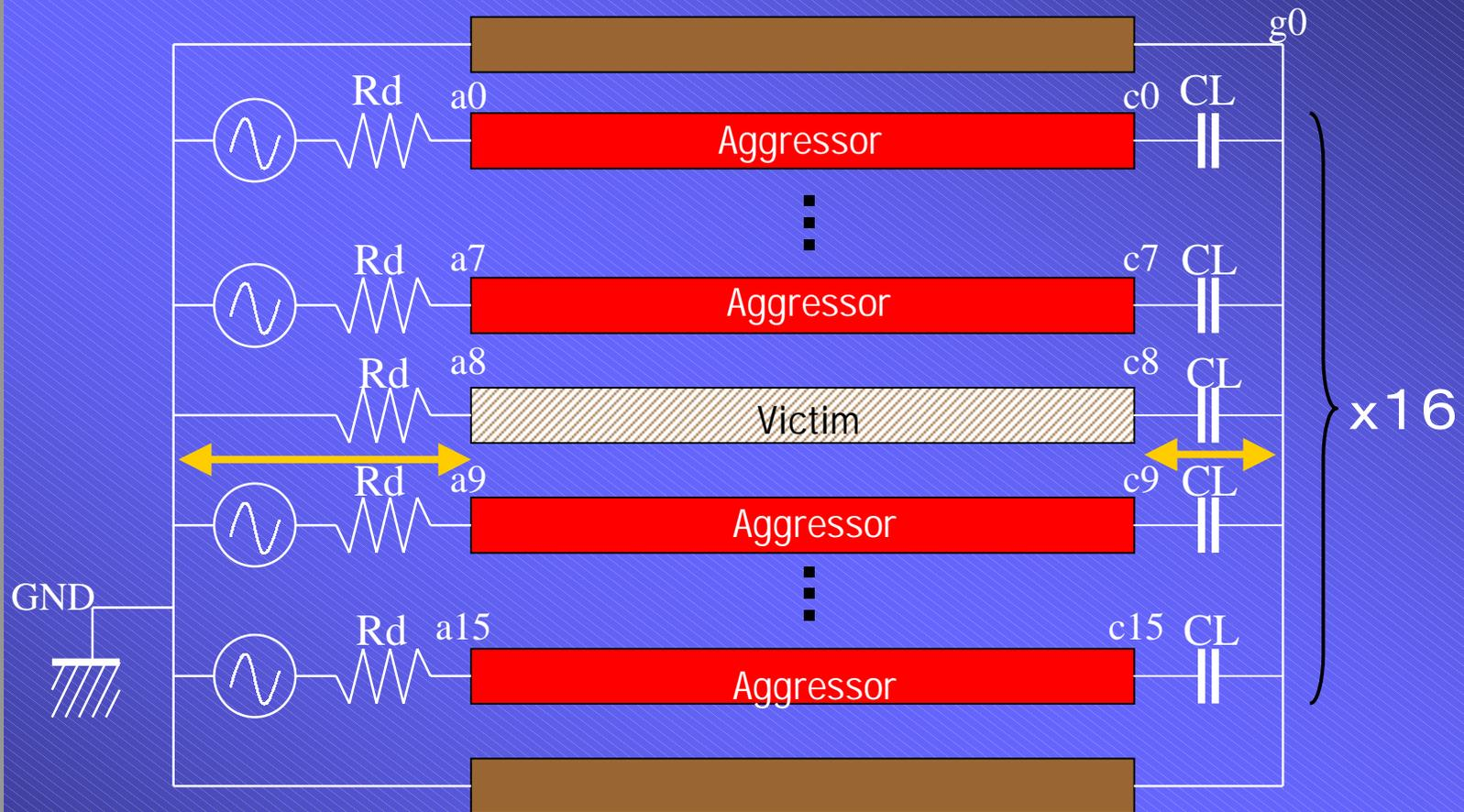
$a_7 - GND$ 、 $a_8 - GND$ 、 $c_8 - g_0$ 、間の電圧を測定
